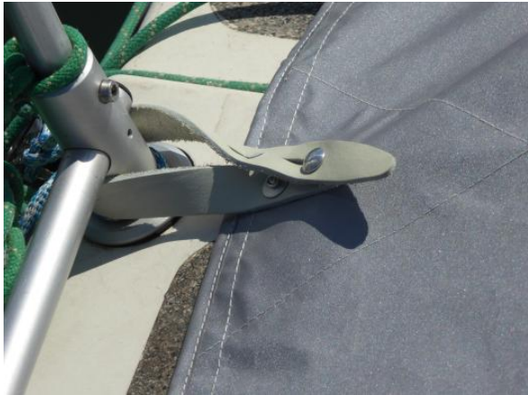
Persenning-Befestigung Relingstange Heck Stb
