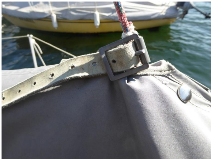
Persenning-Befestigung am Baumende
