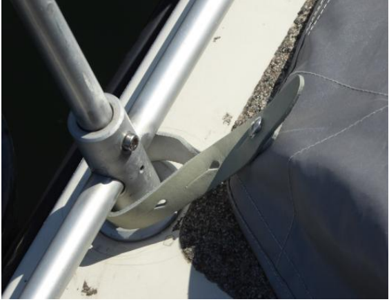
Persenning-Befestigung Relingstange vorn Stb
