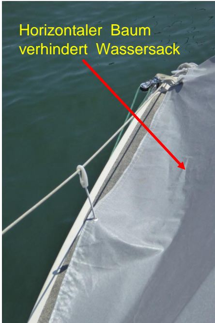
Persenning-Befestigung mit Haken Heck Stb
