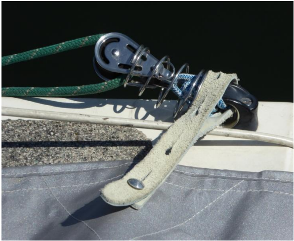
Persenning-Befestigung Heck Stb
