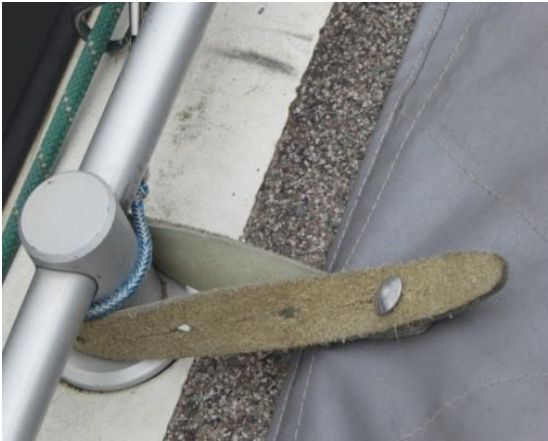
Persenning-Befestigung Relingstange Mitte Stb
