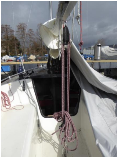
Zuerst Baum horizontal stellen, erst dann Grossschot dicht nehmen.
