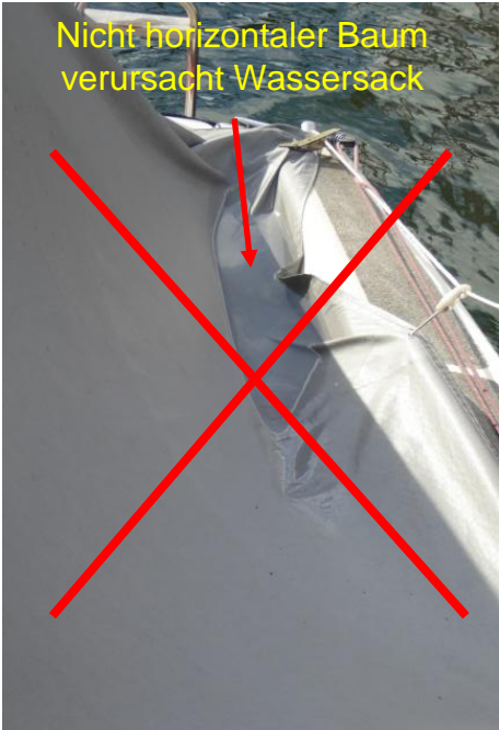
Persenning-Befestigung mit Haken Heck Stb
